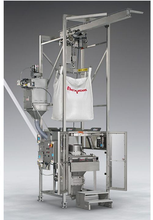
Descargador de Supersacos a Granel Sanitario BULK-OUT® con Sistema de pesaje por lotes, transportador de tornillo flexible integral y colector de polvo BAG-VAC® se muestra con puertas de seguridad con bloqueo en posición abierta y estación para el volteo de sacos manuales con bandeja abatida.
