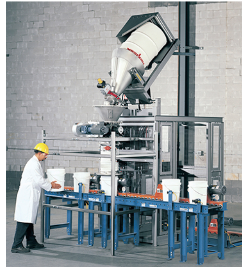
El sistema de llenado de sacos con volcador de tambores de alta elevación transfiere el material de los tambores y llena por pesaje los bidones de manera automática.
